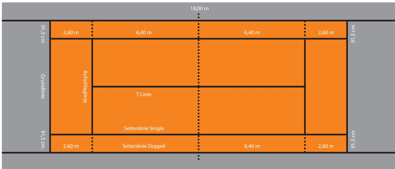
Befestigen Sie die Jugend-Grundlinie (Breite: 4 cm) exakt 2,60 m parallel zur bestehenden Aufschlaglinie mit je zwei Befestigungsnägeln. Die gezogene Länge sollte die Seitenlinie des bestehenden Tennisplatzes erreichen (Länge: 8,23 m).
